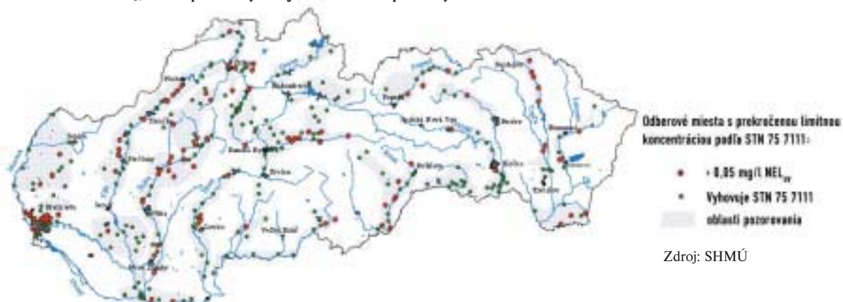
Mapa 8. Koncentrácia NEL_{UV} látok v pozorovaných objektoch SHMÚ v podzemných vodách v roku 2001
